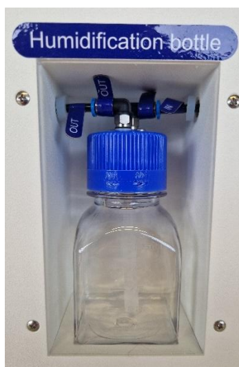
Afbeelding 22.1 Slangaansluiting op de bevochtigingsfles en de Mini MIRI® Humidity IVF-incubator met meerdere kamers
