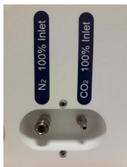
Afbeelding 11.1 Gasinlaten aan de achterkant van Mini MIRI® Dry en Mini MIRI® Humidity IVF-incubatoren met meerdere kamers
